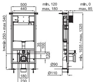
Рама + Универсальный встроенный бачок для подвесного унитаза. Установка в тонкую стену с набором креплений и трубой соединения с унитазом.
