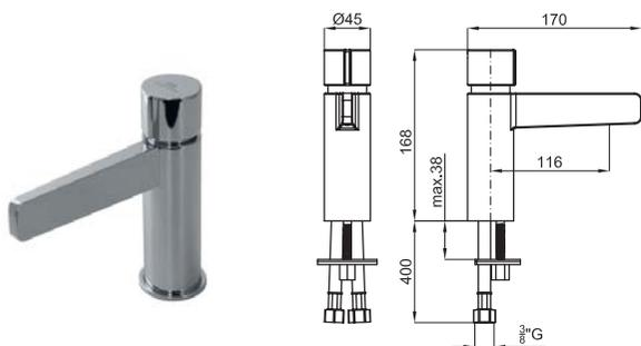
Однорычажный смеситель для раковины с керамическим картриджем. Без донного клапана. Подключение 3/8" длина шлангов - 400мм и плоский азратор. Пропускная способность при 3 бар 5 л/мин.
