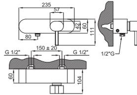
Наружный однорычажный смеситель для душа с керамическим картриджем Ø35 мм. Связь 1/2" и расстояние между выходами 150 +/- 20 мм. Пропускная способность при 3 барах 20,3 л/мин.
