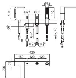
Смеситель для ванны на 4 отверстия. Он включает 1 тип пульта, излив для ванны, переключатель и ручной душ со шлангом 150-см. Связь 1/2". Пропускная способность при 3 барах ванна: 13,64 л/мин. и душа: 13,76 л/мин.
