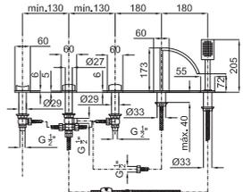
**1** Смеситель для ванны на 3 отверстия. Включает 2 типа пульта и излив. Связь 1/2" и без азуратора. Падение воды каскадом. Пропускная способность при 3 барах 25,54 л/мин.
