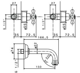
Смеситель для раковины, скрытого монтажа, настенный на 3 отверстия с керамическим картриджем. Связь 1/2", без клапана слива и аэратор "plus". Пропускная способность при 3 барах 18 л/мин.
