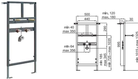
Рама для подвесной раковины. Установка в тонкую стену. Включает комплект креплений и колено-панель для установки подвода воды
