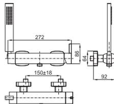
1 Наружный однорычажный смеситель для душа с керамическим картриджем Ø35 мм. Подключение 1/2". Расстояние между выходами 150 +/-15 мм. Включает гибкий шланг для душа 150 см., ручной душ и держатель для ручного душа.
