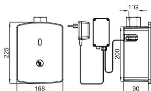
Инфракрасная система смыва для унитаза с пьезоэлектрической кнопкой. Установка в капитальную стену. В комплект входит трансформатор 9В.
