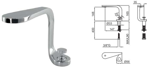
Однорычажный смеситель для раковины с керамическим картриджем Ø25mm. Подключение 3/8". Длина шлангов 365 мм., без сливного клапана. Аэратор "slim". Давление при 3 барах 9 л/мин.
