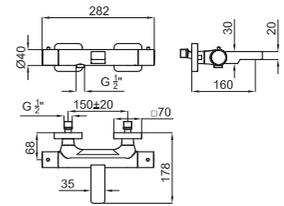
**1** URBAN. Наружный смеситель с термостатом для душа с элементом покрытия из воска. Связь 1/2". Включает обратный клапан и предохранитель на 38° и ECOSTOP. Расстояние между выходами 150 +/-20 мм. Пропускная способность при 3 барах 12 л/мин.
