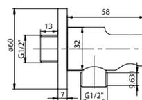
1 Настенный держатель для ручного душа, с подводом воды
