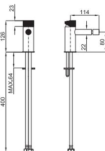
Однорычажный смеситель для биде с ребристой ручкой. Керамический картридж Ø35 мм. Шланги с подключением 3/8" длиной 400 мм. Пропускная способность при 3 бар – 5.68 л/мин.
