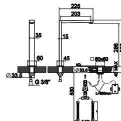
**2** Электронный смеситель для раковины. Связь 3/8", без клапана слива и аэратор "plus". Он включает независимый датчик движения. Пропускная способность при 3 барах 10,5 л/мин.
