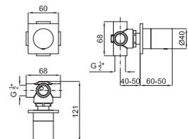
Переключатель 3 пути с подключением 1/2". Пропускная способность при 3 барах душа: 15 л/мин., ванны: 25 л/мин. и верхний душ: 17 л/мин.
