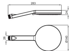
1 HOTELS - Ручной душ с 1 позицией, с системой AIR ECO. Пропускная способность при 3 барах 12 л/мин.
