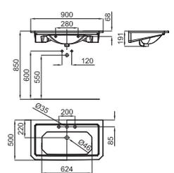
1 IMAGINE. Умывальная раковина-консоль 90 см, подвесная, с переливом. В комплект включен набор крепежных элементов 100040489 - N302160000. Совместима с комплектом ножек для консоли. С одним отверстием для смесителя
