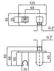
2 Держатель ручного душа с подводом воды, связь 1/2"
