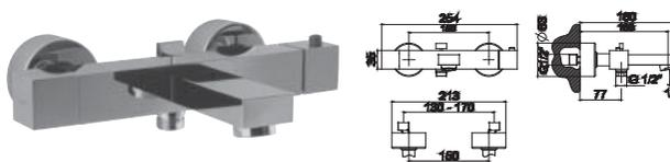
**1** Наружный смеситель с термостатом для душа с элементом покрытия из воска. Связь 1/2", включает обратный и предохранитель на 38°C Расстояние между выходами 150 +/-20 мм. Пропускная способность при 3 барах 17,78 л/мин.
