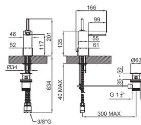
Однорычажный смеситель для раковины с керамическим картриджем типа джойстик Ø32 мм. Связь 3/8", длина шлангов 434-мм., с автоматическим клапаном слива и без азратора. Пропускная способность при 3 барах 5,4 л/мин.
