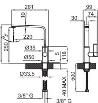
SOFT - Однорычажный смеситель для мойки, поворотный излив. Включает керамический картридж Ø25 мм., с подключением 3/8", длина шлангов 500-мм. Аэратор "Plus".
