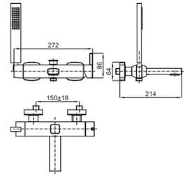
2 Наружный однорычажный смеситель для ванны / душа с керамическим картриджем Ø35 мм. Связь 1/2" автоматический переключатель и аэратор "plus". Расстояние между выходами 150 +/-15 мм. Включает гибкий шланг для душа 175 см., ручной душ и держатель для ручного душа.
