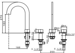
Смеситель для раковины на 3 отверстия с керамическим картриджем. Связь 1/2", без клапана слива и без аэратор. Также присоединяет плоский аэратор, как падения воды каскадом, для выхода. Пропускная способность при 3 барах 6,72 л/мин.
