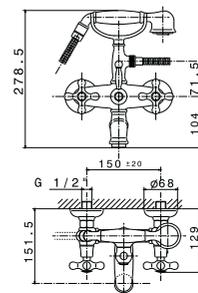
**1** Наружный смеситель-моноблок для душа с керамическим картриджем. Связь 1/2" и азратор "plus". Включает ручной душ со шлангом 150 см. и держатель. Расстояние между выходами 150 +/-20 мм. Пропускная способность при 3 барах 18 л/мин.
