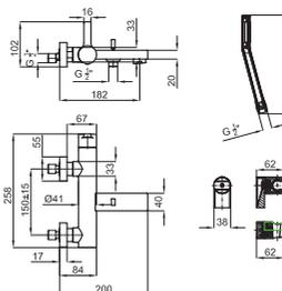
**1** Наружный однорычажный смеситель для душа с керамическим картриджем Ø35 мм. Связь 1/2". Расстояние между выходами 150 +/-15 мм. Он включает гибкие шланги для душа 150 см., ручной душ и держатель для ручного душа. Пропускная способность при 3 барах 11,7 л/мин.
