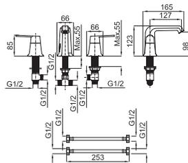
Смеситель для раковины на 3 отверстия с керамическим картриджем. Связь 1/2", без клапана слива. Пропускная способность при 3 барах 9 л/мин.
