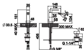
**1** Однорычажный смеситель для биде с керамическим картриджем Ø25 мм. Связь 3/8", длина шлангов 405-мм, с автоматическим клапаном слива и аэратор "plus". Пропускная способность при 3 барах 8 л/мин.
