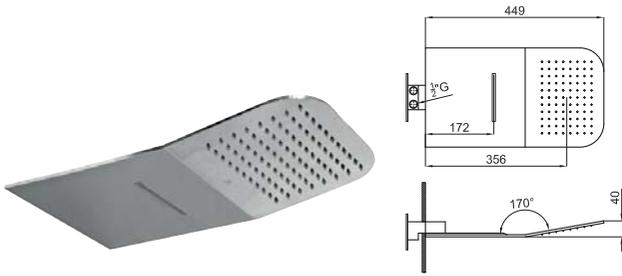
Распылитель с функцией дождевого душа и каскада, подключение 1/2". Пропускная способность при 3 барах дождевого душа: 9 л/мин. и каскада: 9 л/мин.
