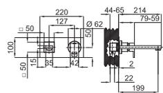
Однорычажный смеситель, скрытого монтажа, с керамическим картриджем Ø35 мм. Связь 1/2", без клапана слива и аэратор "plus". Пропускная способность при 3 барах 12,4 л/мин.
