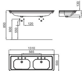
1 Умывальная раковина-консоль 130 см, подвесная, с переливом. В комплект включен набор крепежных элементов 100040489 - N302160000. Совместима с комплектом ножек для консоли. С одним отверстием для смесителя
