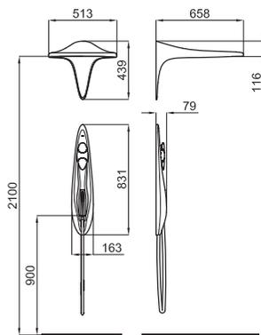
Душевая колонка. Включает смеситель и ручной душ со встроенным держателем.
