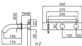
Смеситель-моноблок для ванны, скрытого монтажа, с керамическим картриджем . Связь 1/2". Измерение в 3 барах : 19,03 л/мин.
