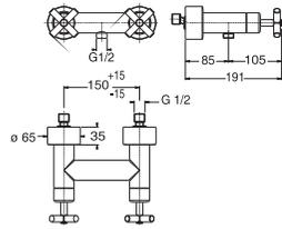
Наружный смеситель-моноблок для душа с керамическим картриджем. Связь 1/2". Расстояние между выходами 150 +/-15 мм. Пропускная способность при 3 барах 33 л/мин.
