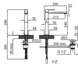
Однорычажный смеситель для раковины с высоким изливом и керамическим картриджем Ø25 мм. Связь 3/8", длина шлангов 360-мм, с клапаном слива автоматическим и аэратор "plus". Пропускная способность при 3 барах 10,5 л/мин.
