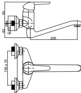
MINI PLUS - Однорычажный смеситель для мойки с поворотным изливом с керамическим картриджем Ø40 mm, с подключением 3/8" и аэратор "plus". Расстояние между выходами 150 +/-20 mm.
