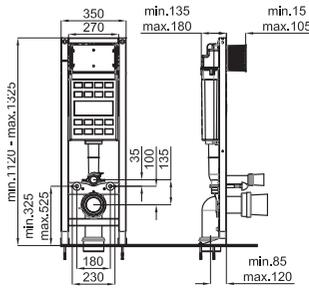
Каркас подвесного унитаза с бачком, самонесущий, шириной 35см. Включает комплект для крепления на стену и трубки для соединения с унитазом.
