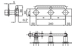
1 Смеситель-моноблок на раковину, скрытого монтажа, с керамическим картриджем. Связь 1/2". Пропускная способность при 3 барах - 50,22 л/мин.
