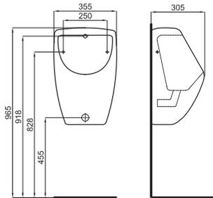
ACRO COMPACT. Писсуар с задним подводом воды и боковым креплением. В комплекте крепеж 100041212 - N420150000. Установка на капитальную или тонкую стену.
