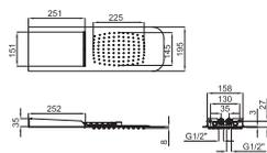
Распылитель дождевого душа с закругленными краем, 60 см, дождевой + каскадный. Пропускная способность при 3 барах дождевого: 14 л/мин. и каскада: 15,50 л/мин.
