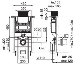
Каркас подвесного унитаза с бачком, укороченный, с подводом сверху или сбоку. Включает комплект для крепления на стену и трубки для соединения с унитазом.
