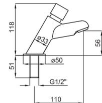
**1** Смесители для раковины с таймером. Рекомендуемое давление функционирования 3 бар. Время функционирования 15 +/-5 сек. в 3 барах. Пропускная способность при 3 барах 13,06 л/мин.
