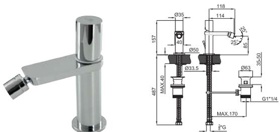
Однорычажный смеситель для биде с керамическим картриджем Ø25 мм. Подключение 3/8", длина шлангов 487мм. Автоматический сливной клапан и аэратор "plus". Открытие на холодную. Пропускная способность при 3 барах 10,8 л/мин.
