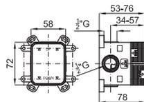
**1** SMART BOX - Универсальный встроенный корпус быстрой установки для смесителя с 1 выходом. С керамическим картриджем Ø35 мм и подключением 1/2". Пропускная способность при давлении 3 бар составляет 22,1 л/мин. В комплект входят 2 глушителя шума и заглушка 1/2".
