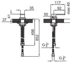
Независимый однорычажный смеситель. Связь 3/8" и без клапана слива. Пропускная способность при 3 барах 11,03 л/мин.
