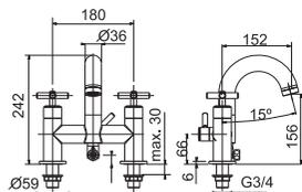
Смеситель-моноблок для ванны / душа, установка на ванну с керамическим картриджем. Подключение 3/4", ручной переключатель и азратор "plus". Расстояние между выходами 180 мм. Пропускная способность при 3 барах 35 л/мин.
