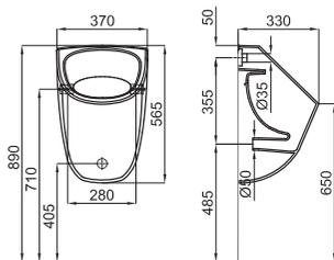
HOTELS. Писсуар с задним подводом и боковым креплением. В комплект входит крепеж 100041212 - N420150000. Установка на капитальную или тонкую стену.
