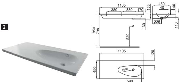
**1** Раковина 110см подвесная с перемещенным углублением направо, слив и крепления 100041225 - N421040000. Держатель полотенец не включает. С отверстием для смесителя
