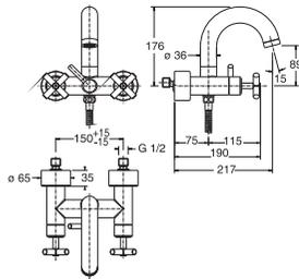
Наружный смеситель-моноблок для ванны / душа с керамическим картриджем. Связь 1/2", ручной переключатель и аэратор "plus". Расстояние между выходами 150 +/-15 мм. Пропускная способность при 3 барах 33 л/мин.
