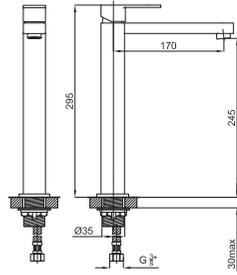
HOTELS - Однорычажный смеситель для мойки, поворотный излив. Включает керамический картридж Ø35 mm., с подключением 3/8", длина шлангов 370-мм. Аэратор "Plus"
