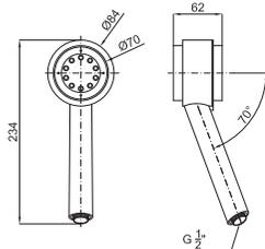
SAZ - Ручной душ 5 функций с подключением 1/2". Функции: Дождь, Софт, Массаж, Дождь+Массаж и Дождь+Софт. Включает систему антиизвести. Пропускная способность при 3 барах: ДОЖДЬ = 17 л/мин.; МАССАЖ = 11,1 л/мин.; СОФТ = 11 л/мин.; ДОЖДЬ+МАССАЖ = 15,2 л/мин.; ДОЖДЬ+СОФТ = 14 л/мин.
