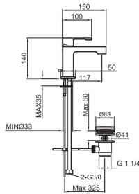
Однорычажный смеситель с керамическим картриджем Ø25 мм. Связь 3/8", длина шлангов 370-мм, с автоматическим клапаном слива luxe и аэратор clean . Пропускная способность при 3 барах 5 л/мин.
