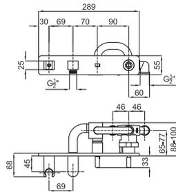
Однорычажный смеситель, скрытого монтажа, для ванны / душа + держатель + подход для воды. Связь 1/2". Автоматический переключатель. Пропускная способность при 3 барах 16,26 л/мин.
