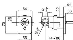
Однорычажный смеситель для душа, скрытого монтажа. Связь 1/2". Пропускная способность при 3 барах 18,57 л/мин.
