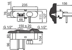
Наружный однорычажный смеситель для ванны/душа с керамическим картриджем Ø35 мм. Связь 1/2", автоматический переключатель и без аэратора. Падение воды каскадом. Расстояние между выходами 150 +/- 20 мм. Пропускная способность при 3 барах 20,3 л/мин.
