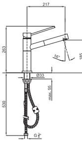
PAL - Однорычажный смеситель для мойки, поворотный излив, с выдвигаемым душем. Включает керамический картридж Ø35 мм, с подключением 3/8", длина шлангов 1500-мм. /530мм, аэратор "Plus" и клапан слива анти-возвращение.
