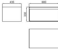
Подвесной модуль шириной 68 см, покрыт блестящим лаком. Ящик с доводчиком обеспечивающим замедленное закрытие.
