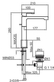
Однорычажный смеситель с высоким изливом и керамическим картриджем Ø25 мм., связь 3/8", длина шлангов 400-мм, с автоматическим клапаном слива luxe и аэратор clean . Пропускная способность при 3 барах 5 л/мин.
