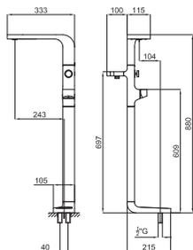
Однорычажный смеситель для ванны / душа монтируемый в пол. Подключение 1/2". Автоматический переключатель. Включает аэратор. В комплект входит ручной душ, шланг и держатель. Напор воды 3 бар ванна 21 л/мин., душ – функция дождь 6 л/мин., спрей 3 л/мин
