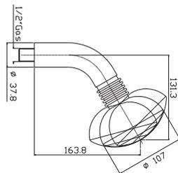
STYLO - Душ стационарный с подключением 1/2". Функции: Дождь, Массаж и Софт. Включает систему антиизвесь.
