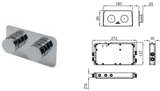
Цифровой термостат на 2 выхода с подключениями 1/2" и обратным клапаном. 2 ручки управления со светодиодной подсветкой. Стоп безопасности. Пропускная способность при 3 бар 27.5 л/мин. В комплект входит трансформатор 100-240V, 50/60 Hz выходное напряжение 15.0V. Термостат независимый 225x130x55мм.
