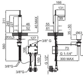
Однорычажный смеситель для раковины с высоким изливом, с керамическим картриджем типа джойстик 32 мм. Связь 3/8", с автоматическим клапаном слива и без азартора. С подсветкой. Он не нуждается в подключении к электрической сети. Пропускная способность при 3 барах 5,4 л/мин.
