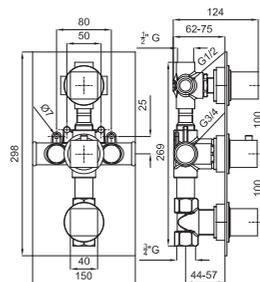
**1** NK LOGIC. Смеситель с термостатом, скрытого монтажа, на 3 отверстия с элементом покрытия из воска. Связь 1/2" - 3/4" согласно плану. Регулирующий переключатель давления. Пропускная способность при 3 барах - 1 выход 26 л/мин, другой 16 л/мин. и последний 45,5 л/мин. Включает 1 выход с большой пропускной способностью и независимой ручкой, обратный клапан и предохранитель на 38°C.
