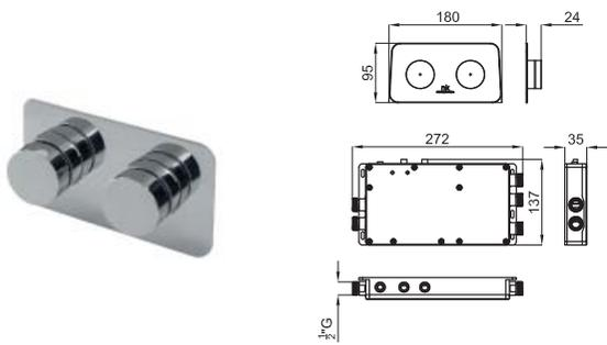
Цифровой термостат на 3 выхода с подключениями 1/2" и обратным клапаном. 2 ручки управления со светодиодной подсветкой. Стоп безопасности. Пропускная способность при 3 бар 27.5 л/мин. В комплект входит трансформатор 100-240V, 50/60 Hz выходное напряжение 15.0V. Термостат независимый 225x130x55мм.
