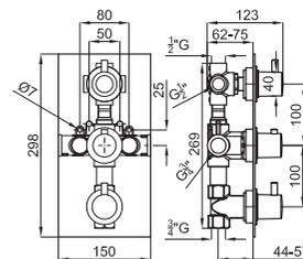
**1** URBAN. Смеситель с термостатом, скрытого монтажа, на 3 отверстия с элементом покрытия из воска. Связи 1/2" - 3/4" согласно плану. Регулирующий переключатель давления. Пропускная способность при 3 барах - 1 выход 26 л/мин., другой с 16 л/мин. и последний 45,5 л/мин. Включает 1 выход большого давления с независимым ручным душем, клапан слива анти-возвращение и предохранитель на 38°C
