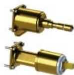
**1** SMART BOX - Универсальный встроенный корпус быстрой установки для смесителя с 2 или 3 выходами. С керамическим картриджем Ø35 мм и подключением 1/2". Пропускная способность всех трех выходов при давлении 3 бар составляет 20,1 л/мин. В комплект входят 2 глушителя шума и 2 заглушки 1/2".
