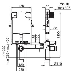
Бачок Универсальный встроенный для унитаза подвесного. Установка в капитальную стену, с набором настенных креплений и трубой соединения с унитазом.
