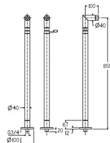
1 Смеситель-моноблок для ванны / душа с керамическим картриджем для установки с набором стоек. Подключение 3/4", ручной переключатель и аэратор "plus". В комплект не входит ручной душ, ни шланг, ни держатель. Пропускная способность при 3 барах 33 л/мин.
