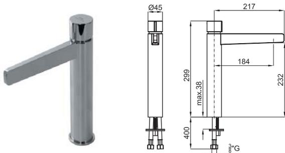
Смеситель для раковины с высоким изливом и керамическим картриджем. Без донного клапана, подключения 3/8", длина шлангов 400мм, плоский азартор. Пропускная способность при 3 бар 5 л/мин.
