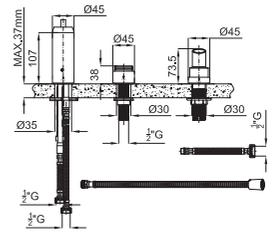
2 PROJECT LINE - Внутренний корпус смесителя, установка на ванне. Керамический картридж TRI-CONTROL Ø40 мм со встроенным переключателем.
