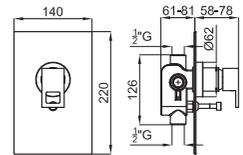
1 Однорычажный смеситель , скрытого монтажа, для душа с керамическим картриджем Ø35 мм. Связь 1/2". Давление в 3 бара - 22 л/мин.
