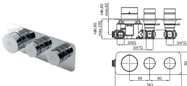
Термостатический смеситель скрытого монтажа на 2 выхода с термоэлементом из воска и обратным клапаном. Подключения 3/4". Пропускная способность при 3 бар 20,4 л/мин для одного выхода и 25,9 л/мин при включении двух выходов.
