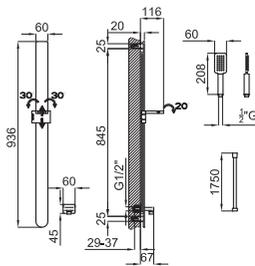
Комплект для душа Forma. В комплект входит душевая Пьедестал с реечным механизмом скольжения и поворотным кронштейном, ручной душ, гибкий шланг с системой анти-скручивания и покрытием из ПВХ, подвод воды
