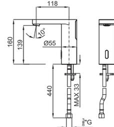
**1** HOTELS - Электронный смеситель с двумя подводами воды, подключение 3/8", без сливного клапана и с азратором "plus". Батарея 3В. Пропускная способность при 3 барах со смешанной водой 5л/мин
