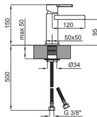
Однорычажный смеситель для биде с керамическим картриджем Ø25 мм. Связь 3/8", длина шлангов 320-мм, без клапана слива. Падение воды каскадом. Пропускная способность при 3 барах 4 л/мин.
