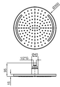
**LIGHT COLOR ROUND** - Распылитель Light Color Round 30см., с шарниром. Функция душа: дождевой. Дополнительная функция: красно-синий свет с сенсором температуры при 38°C (led). Не требует подсоединения к электросети. Минимальное рекомендуемое давление 2 бара. Включает ограничитель. Пропускная способность воды до 12 л/мин.
