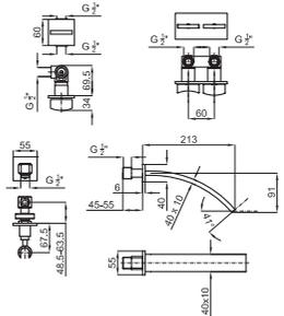
**1** Смеситель, скрытого монтажа, с изливом для ванны. Керамический картридж. Связь 1/2" и излив для ванны, без азуратора. Падение воды каскадом. Пропускная способность при 3 барах 32 л/мин.
