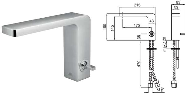
Однорычажный смеситель для раковины с керамическим картриджем Ø25мм. Связь 3/8". Длина шлангов 470 мм., без клапана слива. Включает аэратор, внедренный в излив, который симулирует эффект каскадом, кроме того смеситель со стопором давления в 8 л/мин, чтобы предотвращать забрызгивание.
