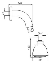
TOSCANA - Душ стационарный с подключением 1/2". Функции: Дождь, Массаж, Пар, Софт, Дождь+Пар и Дождь+Массаж. Включает систему антиизвесть.
