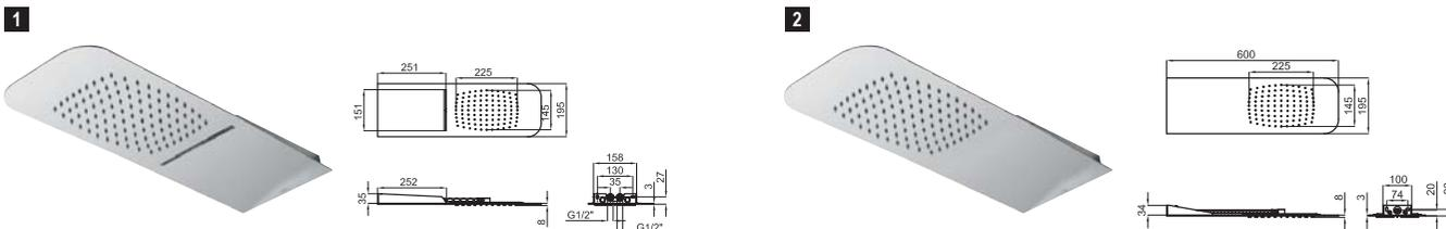
**1** GIRO. Распылитель дождевого душа с закругленными краем, 60 см, дождевой + каскадный. Пропускная способность при 3 барах дождевой: 14 л/мин. и каскада: 15,50 л/мин.
