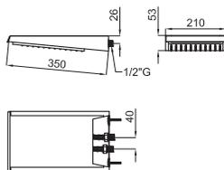
Распылитель с функцией дождевого душа и каскада, с соединениями 1/2". Пропускная способность при 3 барах функцией дождевого душа: 12 л/мин. и каскада: 8,6 л/мин.
