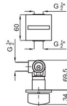
Переключатель скрытого монтажа на 2 выхода. Связь 1/2". Переключатель ручной. Пропускная способность при 3 барах 25,71 л/мин.
