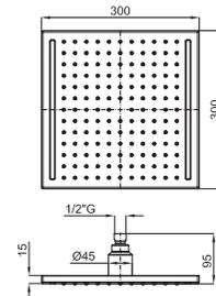
**LIGHT SQUARE** - Распылитель Light Square 30 см, с шарниром. Функция душа: дождевой. Дополнительные функции: белый свет (led). Не требует подсоединения к электросети. Минимальное рекомендуемое давление 2 бара. Включает ограничитель. Пропускная способность воды до 12 л/мин.
