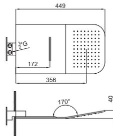
FORMA. Распылитель с функцией дождевого душа и каскада, подключение 1/2". Пропускная способность при 3 барах дождевого душа: 9 л/мин. и каскада: 9 л/мин.
