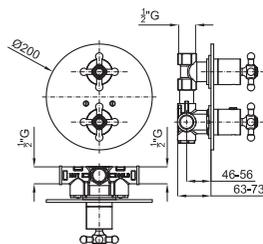
Смеситель с термостатом, скрытого монтажа, с элементом покрытия из воска. Связь 1/2". Пропускная способность при 3 барах - 28,25 л/мин. Он включает обратный и предохранитель на 38°C
