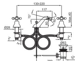
**1** Смеситель-моноблок для биде с керамическим картриджем. Связь 3/8", длина шлангов 390-мм, с автоматическим клапаном слива и азратор "plus". Пропускная способность при 3 барах 18,51 л/мин.
