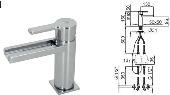
**1** Однорычажный смеситель для раковины с керамическим картриджем Ø25 мм. Связь 3/8", длина шлангов 320-мм, без клапана слива. Падение воды каскадом. Пропускная способность при 3 барах 4 л/мин.
