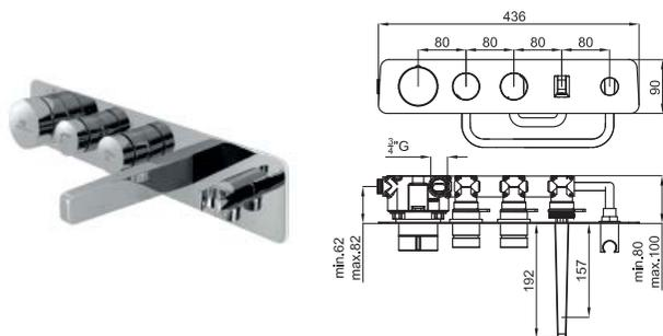
Термостатический смеситель скрытого монтажа с термозлементом из воска, обратным клапаном и изливом для ванны. Подключения 3/4". Пропускная способность при 3 барах душа: 14,6 л/мин. и душа: 16,4 л/мин.
