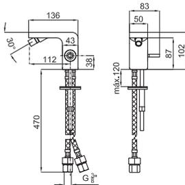
Однорычажный смеситель для биде с картриджем Ø25 мм. Связь 3/8". Длина шлангов 470 мм. Без клапана слива. Пропускная способность при 3 барах 7,6 л/мин.
