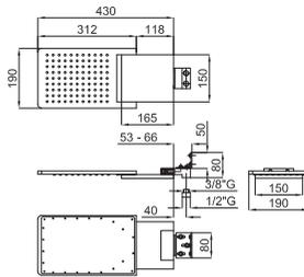
Распылитель с функцией дождевого душа и каскада, с соединениями 1/2". Пропускная способность при 3 барах дождевого: 12,3 л/мин. и каскада: 8,80 л/мин.
