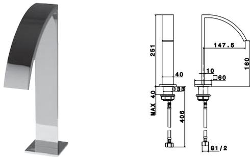
Отдельный высокий излив. Связь 1/2", длина шлангов 406-мм, без клапана слива и без азратора. Падение воды каскадом. Внимание: подход воды только один. Пропускная способность при 3 барах 25,54 л/мин.
