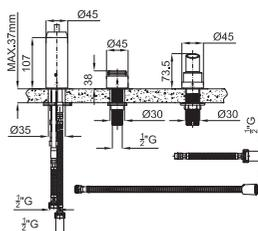
PROJECT LINE - Внутренний корпус смесителя, установка на ванне. Керамический картридж TRI-CONTROL Ø40 мм со встроенным переключателем.
