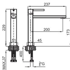
Высокий однорычажный смеситель 229мм, керамический картридж 25 мм. Без донного клапана. Соединения 3/8", длина шланг 400мм. Аэратор "plus". Пропускная способность при 3 барах - 5л/мин.
