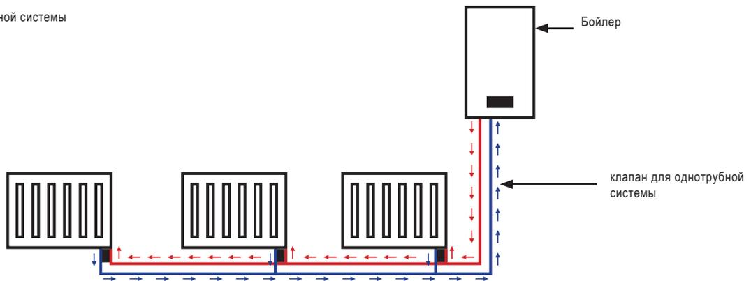
B. - Схема установки двутрубной системы
