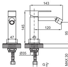
Однорычажный смеситель для биде с керамическим картриджем Ø25 мм. Подключение 3/8", длина шлангов 370-мм., без автоматического клапана слива слива и с аэратор "plus". Пропускная способность при 3 барах 9 л/мин.
