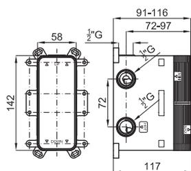
SMART BOX - Универсальный встроенный корпус быстрой установки для смесителя с 2 или 3 выходами. С керамическим картриджем Ø35 мм и подключением 1/2". Пропускная способность всех трех выходов при давлении 3 бар составляет 20,1 л/мин. В комплект входят 2 глушителя шума и 2 заглушки 1/2".
