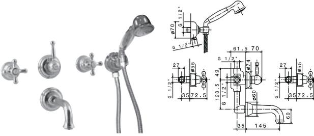
Смеситель, скрытого монтажа, для ванны / душа с керамическим картриджем. Связь 1/2", ручной переключатель и аэратор "plus". Включает ручной душ и гибкие шланги. Пропускная способность при 3 барах душа: 22 л/мин., ванны: 28,4 л/мин.
