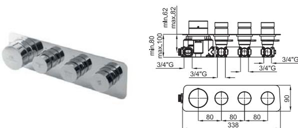
Термостатический смеситель скрытого монтажа на 3 выхода с термоэлементом из воска и обратным клапаном. Подключения 3/4". Пропускная способность при 3 бар 20,4 л/мин для одного выхода и 25,9 л/мин при включении двух выходов.
