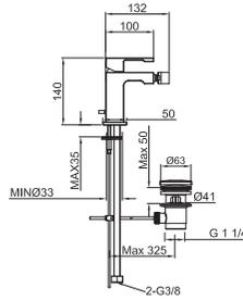
Однорычажный смеситель для биде с керамическим картриджем Ø25 мм., с подключением 3/8", длина шлангов 370-мм, с автоматическим клапаном слива и аэратор clean. Пропускная способность при 3 барах 9,96 л/мин.
