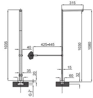
1 Излив для раковины, монтируемый в потолок. Связь 1/2", без клапана слива и азратор "plus". Внимание: он включает только излив. Пропускная способность при 3 барах 12,2 л/мин.
