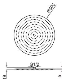
Верхний душ Rondo 50 см., без шарового соединения. Пропускная способность при 3 барах
