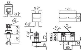
**1** Смеситель-моноблок для душа, скрытого монтажа, с керамическим картиджем . Связь 1/2". Пропускная способность при 3 барах - 23,95 л/мин.
