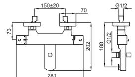
**1** ACRO N. Наружный смеситель с термостатом для душа с элементом покрытия из воска. Связь 1/2". Включает обратный клапан и предохранитель на 38° и ECOSTOP. Расстояние между выходами 150 +/-20 мм. Пропускная способность при 3 барах 17,4&
