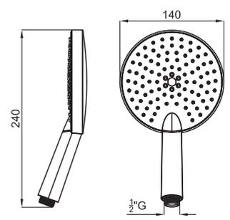
1 PURE LINE. Ручной душ с переключателем и системой AIR ECO. Пропускная способность при 3 бар 12,8 л/мин.
