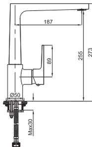
ARQUITECT - Однорычажный смеситель для мойки, поворотный излив. Включает керамический картридж Ø35 мм., с подключением 3/8", длина шлангов 500-мм. Аэратор "Plus".
