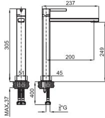
Однорычажный смеситель для раковины 305 мм с высоким изливом и керамическим картриджем Ø25 мм. Подключение 3/8", длина шлангов 400-мм. Открытие на холодную. Без автоматического сливного клапана и с аэратором "plus". Пропускная способность при 3 барах 5 л/мин.
