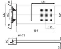
Распылитель с функцией дождевого душа и каскада, подключение 1/2". Пропускная способность при 3 барах (со смешанной водой) дождевого душа: 12 л/мин. и каскада: 15 л/мин.
