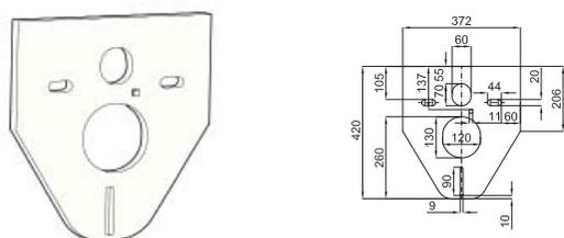
Защитная прокладка с акустической изоляцией для установки между подвесным унитазом или биде и керамической облицовкой стены.
