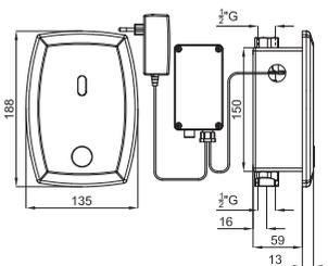
Инфракрасная система смыва для писсуара с пьезоэлектрической кнопкой. Установка в капитальную стену. В комплект входит трансформатор 9В
