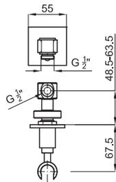
Настенный держатель для ручного душа сподводом воды
