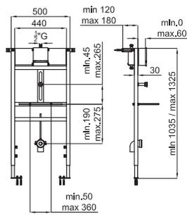
Рама для подвешенного писсуара с инфракрасной системой смыва для установки в тонкую стену. В комплект входит панель с инфракрасным сенсором, крепежные элементы и соединения с писсуаром.
