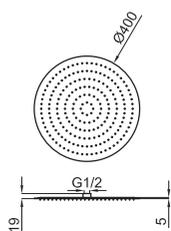
Верхний душ Rondo 40 см., без шарового соединения. Пропускная способность при 3 барах
