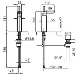
Однорычажный смеситель для раковины с высоким изливом, с керамическим картриджем типа джойстик 32 мм. Связь 3/8", длина шлангов 560-мм с автоматическим клапаном слива и без азартора. Пропускная способность при 3 барах 5,4 л/мин.
