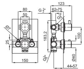
1 Смеситель с термостатом, скрытого монтажа, на 2 отверстия с элементом покрытия из воска. Связи 1/2" - 3/4" согласно плану. Регулирующий переключатель давления. Пропускная способность при 3 барах - 1 выхода 26 л/мин. и другой 13 л/мин. Включает обратный клапан и предохранитель на 38 °
