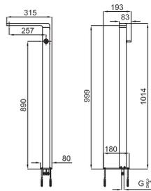
Однорычажный смеситель для раковины, монтируемый в пол. Связь 3/8". Включает аэратор. Пропускная способность при 3 барах 12,23 л/мин.
