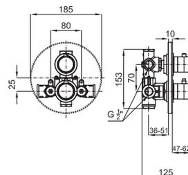
**1** BASIC - Смеситель с термостатом, скрытого монтажа, на 1 отверстие с элементом покрытия из воска. Связь 1/2". Пропускная способность при 3 барах - 25 л/мин. Включает обратный и предохранитель на 38°C
