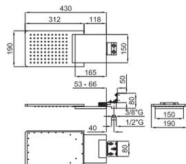
IRTA. Распылитель с функцией дождевого душа и каскада, с соединениями 1/2". Пропускная способность при 3 барах дождевого: 12,3 л/мин. и каскада: 8,80 л/мин.
