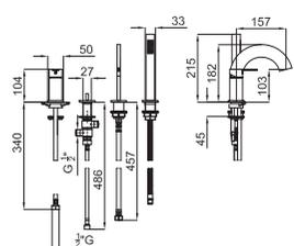
Смеситель для ванны на 4 отверстия. Он включает пульт, излив для ванны, переключатель и ручной душ со шлангом на 150-см . Связь 3/8" и плоский азатор. Пропускная способность при 3 барах ванна: 9,54 л/мин. и душа 11,04 л/мин. .
