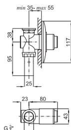
Настенная кнопка смыва скрытого монтажа для унитаза, установка в капитальную стену
