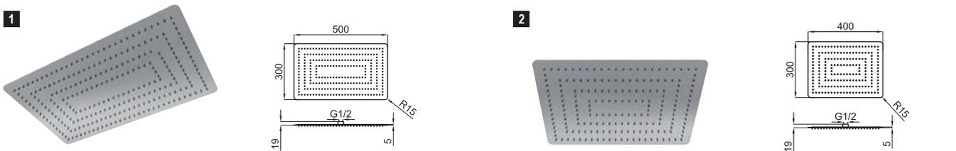
**1** NK LOGIC. Верхний душ Recto 50x30 см., без шарового соединения. Пропускная способность при 3 барах
