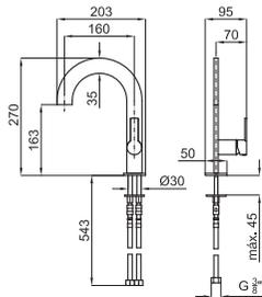
Однорычажный смеситель для раковины с керамическим картриджем Ø28 мм. Связь 3/8", длина шлангов 460-мм, без клапана слива и с плоским эффектом падения воды каскадом. Пропускная способность при 3 барах 6,03 л/мин.
