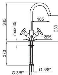
MONOBLOCK FUTURE - Смеситель-моноблок для мойки с керамическим картриджем. Длина шлангов 500мм, поворотный излив. Аэратор "Plus"
