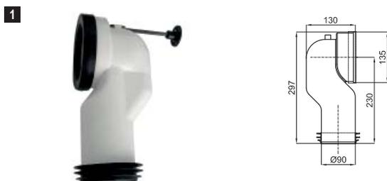
**1** Выпускное колено для унитаза с направляемым выходом с уплотнителем, возможно подключение к канализационным трубам диаметром 90-110мм
