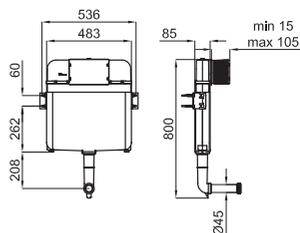
Универсальный встроенный бачок для отдельностоящего унитаза. В комплект входят крепежные элементы и трубы соединения с унитазом.
