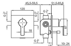
1 Однорычажный смеситель для душа, скрытого монтажа, с керамическим картриджем Ø35 мм. Связь 1/2" и давлением в 3 барах - 24,47 л/мин.
