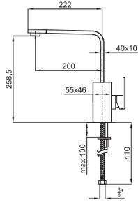
NEXT - Однорычажный смеситель для мойки, поворотный излив. Включает керамический картридж Ø35 мм. с подключением 3/8", длина шлангов 410-мм, аэратор "Plus" и обратный.
