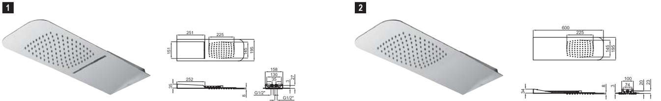
**1** GIRO. Распылитель дождевого душа с закругленными краем, 60 см. дождевой + каскадный. Пропускная способность при 3 барах дождевого: 14 л/мин. и каскада: 15.50 л/мин.
