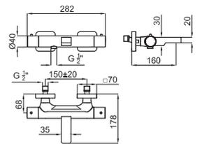
1 Наружный смеситель с термостатом для душа с элементом покрытия из воска. Связь 1/2". Включает обратный клапан и предохранитель на 38 ° и ECOSTOP. Расстояние между выходами 150 +/-20 мм. Пропускная способность при 3 барах 12 л/мин.
