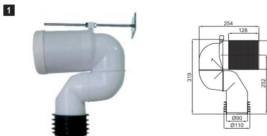
**1** Регулируемое выпускное колено с уплотнителем для унитаза с направляемым выходом. Возможно подключение к канализационным трубам диаметром 90-110мм
