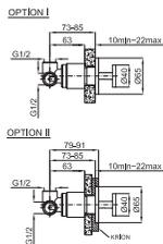
Однорычажный Универсальный встроенный настенный смеситель для комплекта гигиенического душа. В случае установки с панелью для аксессуаров из KRION®, она должна быть независимой (100123750 - N899999869, 100123752 - N899999870 или 100123751 - N899999873) или необходимо заказывать комплект с независимой панелью для 3 аксессуаров (100138281 - N387000039, 100138275 - N387000043, 100138282 - N387000041, 100138274 - N387000040, 100138264 - N387000044 или 100138126 - N387000042)
