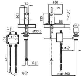
Однорычажный смеситель для раковины с керамическим картриджем типа джойстик Ø32 мм. Связь 3/8", с автоматическим клапаном слива и без азратора. С подсветкой. Он не нуждается в подключении к электрической сети. Длина шлангов 634 мм. Пропускная способность при 3 барах 5,4 л/мин.
