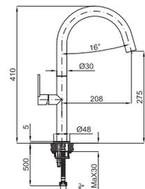
**1** URBAN - Однорычажный смеситель для мойки, поворотный излив, с выдвижным душем. Включает керамический картридж Ø25, с подключением 3/8", длина шлангов 500-мм. Аэратор "Plus".
