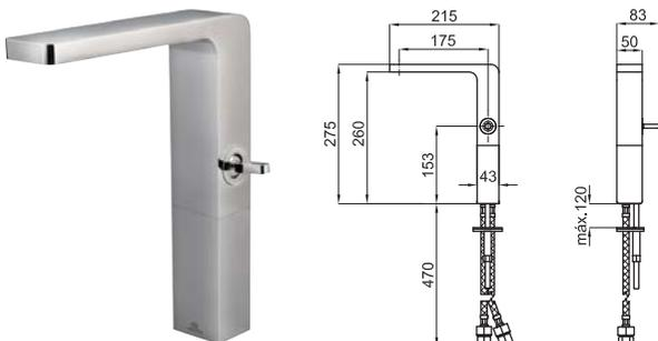
Однорычажный смеситель для раковины с высоким изливом и керамическим картриджем Ø25 мм. Связь 3/8". Длина шлангов 470 мм., без клапана слива. Включает аэратор, внедренный в излив, который симулирует эффект падения воды каскадом, кроме того смеситель со стопором давления в 8 л/мин, чтобы предотвращать забрызгивание.
