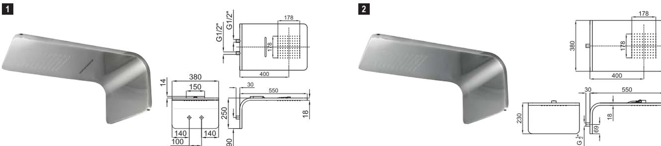
**1** LOUNGE. Распылитель с функцией дождевого душа и каскада, с соединениями 1/2". Пропускная способность при 3 барах Функция дождь 10,8 л/мин. и функция каскад 11,4 л/мин
