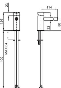
Однорычажный смеситель для биде. Керамический картридж Ø35 мм. Шланги с подключением 3/8" длиной 400 мм. Пропускная способность при 3 бар – 5.68 л/мин.
