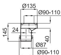
Эксцентриковый манжет для унитаза с вертикальным выходом позволяет небольшое боковое перемещение. Для подключения унитаза с вертикальным выходом к канализационным трубам 90-110мм.
