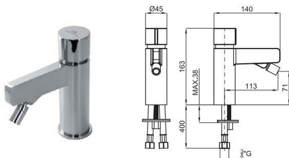
Смеситель для биде с керамическим картриджем. Подключения 3/8" и длина шлангов 400мм. Плоский азартор. Пропускная способность при 3 бар 5 л/мин.
