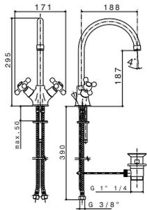
**1** Смеситель-моноблок для раковины с керамическим картриджем . Связь 3/8", длина шлангов 390-мм, с автоматическим клапаном слива и аэратор "plus". Пропускная способность при 3 барах 17,69 л/мин.
