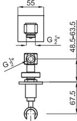
Настенный держатель для ручного душа с подводом воды
