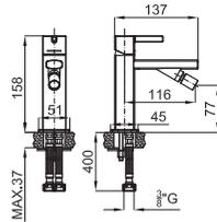
Однорычажный смеситель для биде с керамическим картриджем Ø25 мм. Подключение 3/8", длина шлангов 400-мм., без автоматического сливного клапана и с аэратором "plus" "plus". Пропускная способность при 3 барах 5 л/мин.
