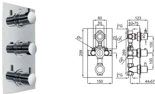
**1** Смеситель с термостатом, скрытого монтажа, на 3 отверстия с элементом покрытия из воска. Связи 1/2" - 3/4" согласно плану. Регулирующий переключатель давления. Пропускная способность при 3 барах - 1 выход 26 л/мин., другой с 16 л/мин. и последний 45,5 л/мин. Включает 1 выход большого давления с независимым ручным душем, клапан слива анти-возвращения и предохранитель на 38°C
