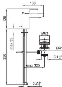
Однорычажный смеситель для раковины с керамическим картриджем Ø35 мм., связь 3/8", длина шлангов 370-мм, с автоматическим клапаном слива и аэратор "plus". Пропускная способность при 3 барах 12,01 л/мин.
