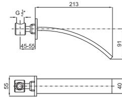
Излив для ванны, скрытого монтажа. Связь 1/2" и без азуратора. Падение воды каскадом. Пропускная способность при 3 барах 32 л/мин.
