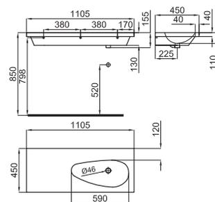
1 Раковина 110см подвесная с перемещенным углублением направо, слив и крепления 100041225 - N421040000. Держатель полотенец не включает. С отверстием для смесителя
