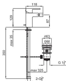
Однорычажный смеситель для биде с керамическим картриджем Ø35 мм., связь 3/8", длина шлангов 370-мм, с автоматическим клапаном слива и азратор "plus". Пропускная способность при 3 барах 12,08 л/мин.
