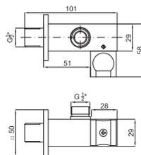
Настенный держатель для ручного душа, с подводом воды
