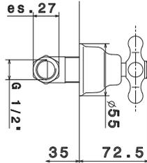
Перепускной вентиль, скрытого монтажа 1/2". Пропускная способность при 3 барах 30,3 л/мин.
