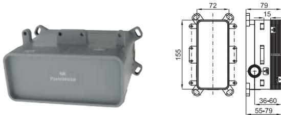
корпус SMART BOX BATH для установки смесителя для раковины. Керамический картридж Ø35мм и соединения 1/2". Возможность установки в горизонтальном и вертикальном положении.
