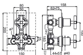
Смеситель с термостатом, скрытого монтажа, на 2 отверстия с элементом покрытия из воска. Связи 1/2"- 3/4" согласно плану и регулирующий переключатель давления. Пропускная способность при 3 барах - для ванны 26 л/мин. и душ 13 л/мин. включает клапан анти-возвращения и предохранитель на 38°C
