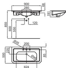
1 Умывальная раковина-консоль 90 см, подвесная, с переливом. В комплект включен набор крепежных элементов 100040489 - N302160000. Совместима с комплектом ножек для консоли. С одним отверстием для смесителя
