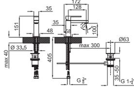
Однорычажный смеситель для раковины, хромированный с керамическим картриджем Ø25 мм. Связь 3/8", длина шлангов 405-мм, с автоматическим клапаном слива и аэратор "plus". Пропускная способность при 3 барах 10,5 л/мин.
