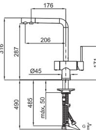
OSMOSIS - Однорычажный смеситель для мойки, поворотный излив, для фильтрации осмос, с керамическим картриджем, Ø35 мм., с подключением 3/8", длина шлангов 485-мм. Смеситель не включает комплект фильтров. Аэратор "Plus".
