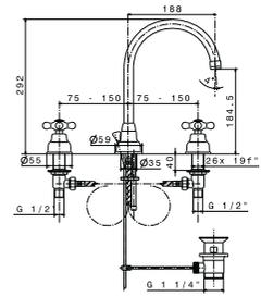
**1** Смеситель для раковины на 3 отверстия с керамическим картриджем. Связь 1/2", длина шлангов 365-мм, с автоматическим клапаном слива и аэратор "plus". Пропускная способность при 3 барах 19,26 л/мин.
