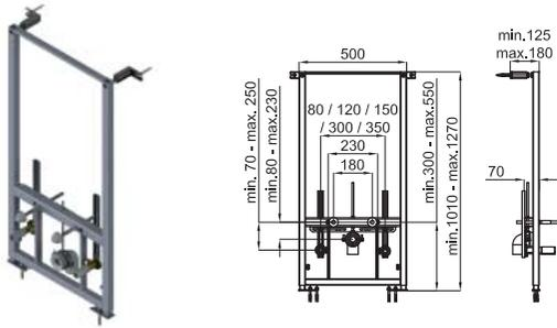
Рама для подвесного биде. Установка в тонкую стену. Включает комплект креплений и колено-панель для установки подвода воды
