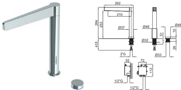
PURE LINE - Кухонный электронный смеситель с поворотным изливом и отдельной кнопкой управления. Подключения 1/2", стоп безопасности, батарея, плоский азратор. Необходимо подключение к электросети. В комплект входит трансформатор 100-240V, 50/60 Hz выходное напряжение 9.0V. Наружный смеситель 85x75x55мм.
