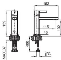
Однорычажный смеситель для раковины с керамическим картриджем Ø25 мм. Подключение 3/8", длина шлангов 400-мм., без автоматического клапана слива слива и с аэратор "plus". Открытие на холодную Пропускная способность при 3 барах 5 л/мин.
