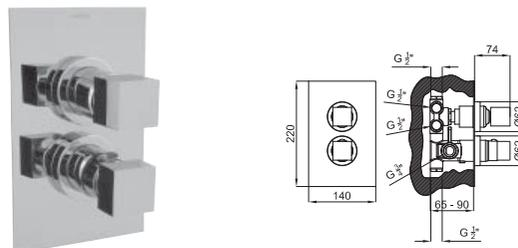
**1** Смеситель с термостатом, скрытого монтажа, на 1 отверстие, с элементом покрытия из воска. Связи 1/2"- 3/4" согласно плану. Пропускная способность при 3 барах – с 18,2 л/мин. Он включает обратный и предохранитель на 38°C
