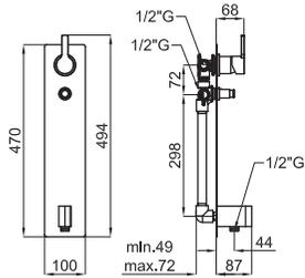
Однорычажный смеситель скрытого монтажа для ванны / душа, с керамическим картриджем Ø35 мм. Связь 1/2". Он не включает ни ручной, ни гибкий душ. Пропускная способность при 3 барах душа: 14,9 л/мин. и ванны: 20,2 л/мин.
