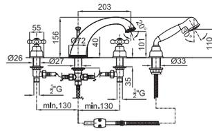
Смеситель на 4 отверстия, настенный. Он включает два типа пульта, излив для ванны с переключателем и ручной душ со шлангом 150-см. Связь 1/2" и аэратор "plus". Пропускная способность при 3 барах душа: 20,54 л/мин., ванны: 23,17 л/мин. Гибкий шланг ручного душа поставляется в хромированном исполнении для всех видов отделки.
