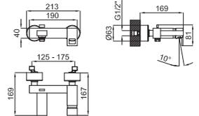
1 Наружный однорычажный смеситель для душа с керамическим картриджем Ø35 мм. Связь 1/2". Расстояние между выходами 150 +/-25 мм. Пропускная способность при 3 барах 10,2 л/мин.
