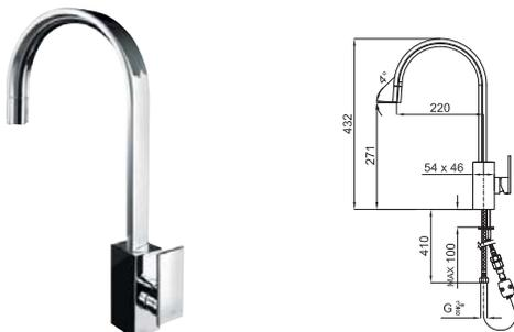
LOOP - Однорычажный смеситель для мойки, поворотный излив, с выдвигаемым душем. Включает керамический картридж Ø35 мм. с подключением 3/8", длина шлангов 410-мм, азратор скрытый "plus", обратный клапан и длина шлангов для душа 150-см.
