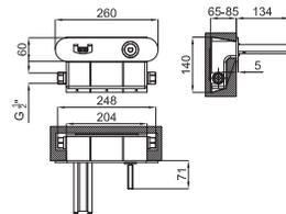
Однорычажный смеситель для раковины, скрытого монтажа, открытый с керамическим картриджем типа джойстик Ø32 мм. Связь 1/2", без клапана слива и без азартора. Падение каскадом. Пропускная способность при 3 барах 5,4 л/мин.
