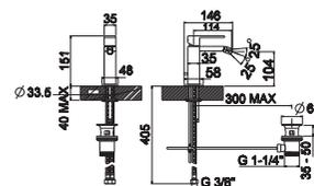
**2** Хромированный однорычажный смеситель для биде с керамическим картриджем Ø25 мм. Связь 3/8", длина шлангов 405-мм, с автоматическим клапаном слива и аэратор "plus". Пропускная способность при 3 барах 10,5 л/мин.
