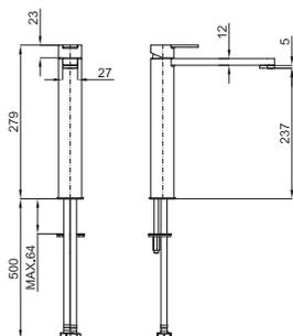
Однорычажный смеситель для раковины с высоким изливом и керамическим картриджом Ø25 мм
