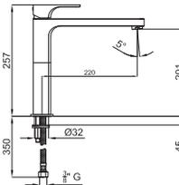
NK LOGIC - Однорычажный смеситель для мойки, поворотный излив. Включает керамический картридж Ø25 мм., с подключением 3/8", длина шлангов 350-мм. Аэратор "Plus".
