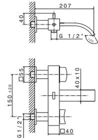
**1** Наружный смеситель-моноблок для душа с керамическим картиджем . Связь 1/2", расстояние между выходами 150 +/-20 мм. Пропускная способность при 3 барах 30,56 л/мин.
