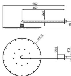
Комплект верхнего душа 400мм + кронштейн 450мм. Пропускная способность при 3 бар – 20 л/мин.
