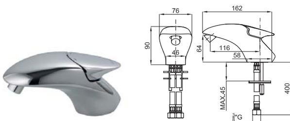
Однорычажный смеситель для биде с керамическим картриджем 25 мм. Без донного клапана. Подключения 3/8", длина шлангов 400 мм. Аэратор "plus". Пропускная способность при 3 бар 7,5 л/мин.
