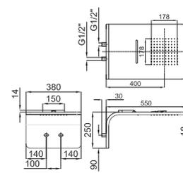
**1** Распылитель с функцией дождевого душа, с соединениями 1/2". Пропускная способность при 3 барах 10,75 л/мин.
