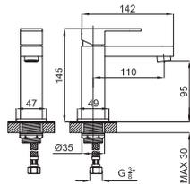
Однорычажный смеситель для раковины с керамическим картриджем Ø25 мм. Подключение 3/8", длина шлангов 370-мм., без автоматического клапана слива слива и с аэратор "plus". Пропускная способность при 3 барах 5 л/мин.
