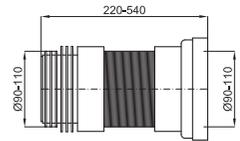
1 Эксцентриковое сливное колено, для унитазов с направляемым выходом, с мультишвом и болтом для крепления к стене.
