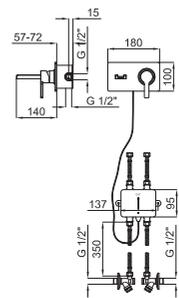
**1** Однорычажный смеситель для раковины, скрытого монтажа, открытый излив с керамическим картриджем типа джойстик Ø25 мм. Связь 1/2", без клапана слива и без аэратора. Эффект падения воды каскадом. Пропускная способность при 3 барах 4 л/мин.
