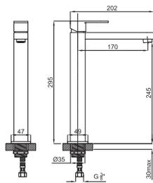
Однорычажный смеситель для раковины с высоким изливом и керамическим картриджем Ø25 мм. Подключение 3/8", длина шлангов 400-мм., без автоматического клапана слива слива и с аэратор "plus". Пропускная способность при 3 барах 5 л/мин.
