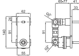
Однорычажный смеситель для ванны / душа скрытого монтажа. Связь 1/2". Автоматический переключатель. Пропускная способность при 3 барах 16,58 л/мин.
