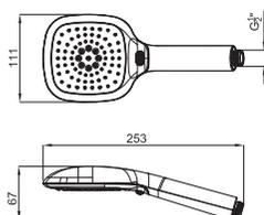
URBAN - Ручной душ с 2 функциями, с переключателем функций дождевого душа и массажа. Пропускная способность при 3 барах: ДОЖДЬ = 11,78 л/мин.; МАССАЖ = 12,06 л/мин.; ДОЖДЬ+МАССАЖ = 15,14 л/мин.
