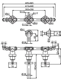
Смеситель, скрытого монтажа, для ванны / душа на 3 отверстия с керамическим картриджем. Связь 1/2" и ручной переключатель регулирующий давление. Пропускная способность при 3 барах для душа: 16 л/мин. и для ванны : 22 л/мин
