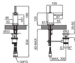
Однорычажный смеситель для биде с керамическим картриджем типа джойстик Ø32 мм. Связь 3/8", длина шлангов 634-мм, с клапаном слива автоматическим и без азартора. Падение воды каскадом. Пропускная способность при 3 барах 5,4 л/мин.
