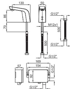
SQUARE - Электронный смеситель с двумя подводами воды, подключение 1/2" без сливного клапана и с азратором "plus". Батарея 6В. Пропускная способность при 3 барах - 5 л/мин.
