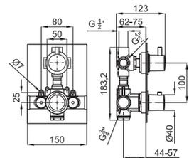
**1** URBAN. Смеситель с термостатом, скрытого монтажа, на 2 отверстия с элементом покрытия из воска. Связи 1/2" - 3/4" согласно плану. Регулирующий переключатель давления. Пропускная способность при 3 барах - 1 выхода 26 л/мин. и другой 13 л/мин. Включает обратный клапан и предохранитель на 38°
