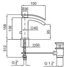
Однорычажный смеситель для раковины с керамическим картриджем Ø28 мм. Связь 3/8", длина шлангов 512-мм, с автоматическим клапаном слива и без аэратора. Падение воды каскадом. Пропускная способность при 3 барах 7,85 л/мин.
