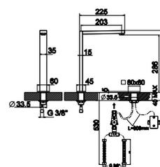
**1** IRTA. Электронный смеситель для раковины со подключениями 3/8", без клапана слива и аэратор "plus". Два подвода воды, регулировка температуры производится под столешницей. Пропускная способность при 3 барах 10,5 л/мин.
