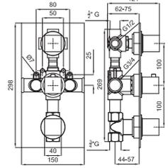
1 Смеситель с термостатом, скрытого монтажа, на 3 отверстия с элементом покрытия из воска. Связи 1/2"- 3/4" согласно плану. Регулирующий переключатель давления. Пропускная способность при 3 барах - 1 выход 26 л/мин, другой 16 л/мин. и последний 45,5 л/мин. Включает 1 выход с большой пропускной способностью и независимой ручкой, обратный клапан и предохранитель на 38°C.
