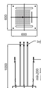
**1** Верхний душ встраиваемый в потолок 40см. Основные функции: дождь, пар и центральная струя. Дополнительная функция: хромотерапия. В комплект входит пульт управления хромотерапией с защитой IP67. Напряжение питания 220В. Смеситель не входит в комплект. Для обеспечения нормальной работы душа необходимо заказывать смеситель с 3 выходами. Минимально необходимая пропускная способность 16 л/мин.
