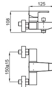
**1** Наружный однорычажный смеситель с керамическим картриджем Ø35 мм. и связь 1/2". Расстояние между выходами 150 +/-15 мм. Пропускная способность при 3 барах 20,08 л/мин.
