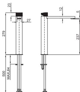
Однорычажный смеситель для раковины с высоким изливом и ребристой ручкой. Керамический картридж Ø25 мм. Шланги с подключением 3/8" длиной 500мм. Пропускная способность при 3 бар – 5.68 л/мин.
