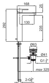
Однорычажный смеситель для раковины с высоким изливом и керамическим картриджем Ø35 мм., связь 3/8", длина шлангов 370-мм, с автоматическим клапаном слива и аэратор "plus". Пропускная способность при 3 барах 12,01 л/мин.
