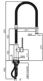
SPRING - Однорычажный смеситель для мойки, поворотный излив. Включает керамический картридж Ø35 мм., с подключением 3/8", длина шлангов 500-мм. Аэратор "Plus".
