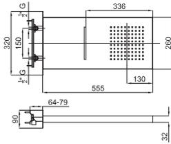
NK LOGIC. Распылитель с функцией дождевого душа и каскада, подключение 1/2".
