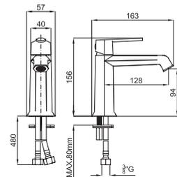
Однорычажный смеситель для раковины с керамическим картриджем Ø25 мм. Связь 3/8", длина шлангов 480-мм, без клапана слива. Пропускная способность при 3 барах 9 л/мин.
