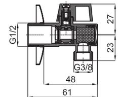
1 AERO - запорный вентиль с разборным фильтром, подключением 1/2"
