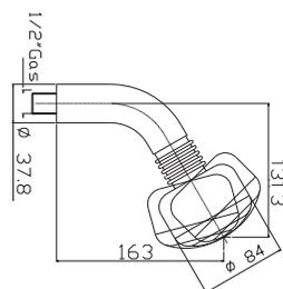
MEDIA - Душ стационарный с подключением 1/2". Функции: Дождь, Массаж и Софт. Включает систему антиизвесь.
