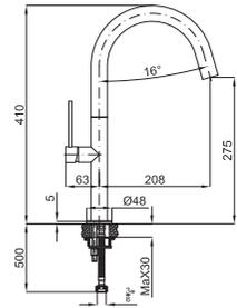
**1** URBAN STICK - Однорычажный смеситель для мойки, поворотный излив, с выдвижным душем. Включает керамический картридж Ø25, с подключением 3/8", длина шлангов 500-мм. Аэратор "Plus".
