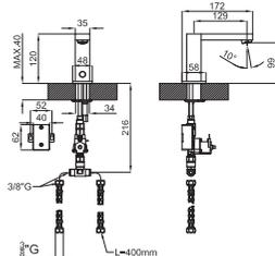
**1** Электронный смеситель для раковины со подключениями 3/8", без клапана слива и аэратор "plus". Два подвода воды, регулировка температуры производится под столешницей. Пропускная способность при 3 барах 10,5 л/мин.
