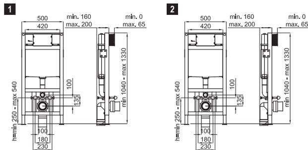
1 Рама + Универсальный встроенный бачок для унитаза подвесного, система самонесущая с набором настенных креплений и трубой соединения с унитазом.
