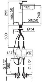
**1** Однорычажный смеситель для раковины с высоким изливом и керамическим картриджем Ø25 мм. Связь 3/8", длина шлангов 320-мм. без клапана слива. Падение воды каскадом. Пропускная способность при 3 барах 4 л/мин.
