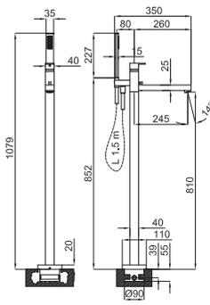
Однорычажный смеситель для ванны/душа, монтируемый в пол с керамическим картриджем Ø35 мм. Связь 1/2", автоматический переключатель и азратор "plus". Диаметр 90 мм. в основании. Пропускная способность при 3 барах душа: 7,8 л/мин. и ванны: 20,3 л/мин.
