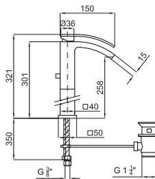
Однорычажный смеситель для раковины с высоким изливом и керамическим картриджем Ø28 мм. Связь 3/8", длина шлангов 350-мм, с автоматическим клапаном слива и без аэратор. Падение воды каскадом. Пропускная способность при 3 барах 7,51 л/мин.
