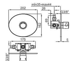
**1** Смеситель для душа, скрытого монтажа, с таймером. Связь 1/2". Рекомендуемое давление 3 бар. Время функционирования 15 +/-5 сек. в барах. Пропускная способность при 3 барах 17 л/мин.
