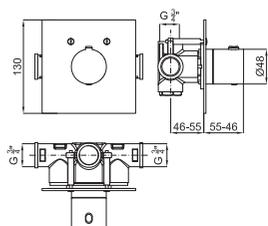
Смеситель с термостатом, скрытого монтажа включает элемент покрытия из воска. Связь 3/4". Он включает обратный и предохранитель на 38°C Пропускная способность при 3 барах 57,9 л/мин. Обязательно использовать этот продукт вместе с перепускным вентилем как минимум 100063492-N199999979 или как минимум переключатель с положением СТОП.
