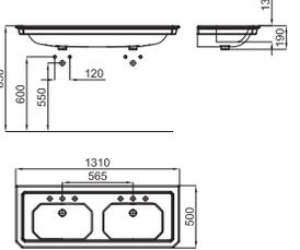
1 IMAGINE. Умывальная раковина-консоль 130 см, подвесная, с переливом. В комплект включен набор крепежных элементов 100040489 - N302160000. Совместима с комплектом ножек для консоли. С одним отверстием для смесителя
