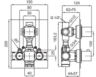
1 Смеситель с термостатом, скрытого монтажа, на 2 выхода с элементом покрытия из воска. Связи 1/2"- 3/4" согласно плану. Регулирующий переключатель давления. Пропускная способность при 3 барах - 1 выход 26 л/мин. и другой 13 л/мин. Включает обратный клапан и предохранитель на 38°C
