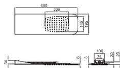
Распылитель дождевого душа с закругленными краем, 60 см. Пропускная способность при 3 барах 14 л/мин.
