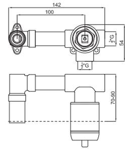
1 Наружная часть однорычажного смесителя для раковины скрытого монтажа с ребристой ручкой и круглым изливом. Пропускная способность при 3 барах 5,68 л/мин
