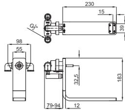
Однорычажный смеситель, скрытого монтажа, с керамическим картриджем Ø25 мм. Связь 1/2". Без клапана слива. Включает аэратор. Пропускная способность при 3 барах 9,92 л/мин.
