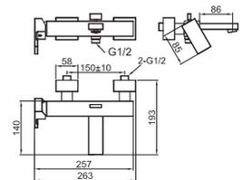
**1** Наружный однорычажный смеситель для душа с керамическим картриджем 35-мм и связью 1/2". Расстояние между выходами 150 +/-10 мм. Пропускная способность при 3 барах 25,74 л/мин.
