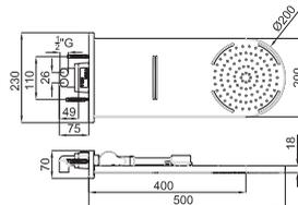
LIGHT WALL - Распылитель на стену 50x23. Функции душа: дождевой и каскадный.
