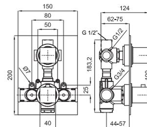
**1** NK LOGIC. Смеситель с термостатом, скрытого монтажа, на 2 выхода с элементом покрытия из воска. Связи 1/2" - 3/4" согласно плану. Регулирующий переключатель давления. Пропускная способность при 3 барах - 1 выход 26 л/мин. и другой 13 л/мин. Включает обратный клапан и предохранитель на 38°C
