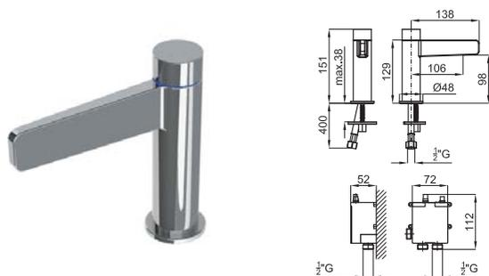
Электронный смеситель для раковины с подключениями 1/2". Без донного клапана. Стоп безопасности, батарея. Необходимо подключение к электросети. Плоский азратор. В комплект входит трансформатор 100-240V, 50/60 Hz, выходное напряжение 9.0V. Наружный смеситель 85x75x55мм.
