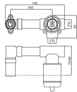
1 Наружная часть однорычажного смесителя для раковины скрытого монтажа с ребристой ручкой и прямоугольным изливом. Пропускная способность при 3 барах 5,68 л/мин
