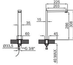
Независимый высокий излив. Связь 3/8", без клапана слива и азратор "plus".
