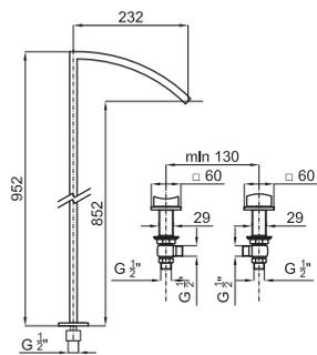
Комплект перепускных вентилях для установки на ванну с изливом, монтируемый в пол. Включает 2 типа пульта и монтаж в пол. Связь 1/2" и без азратора. Падение воды каскадом. Пропускная способность при 3 барах 27,31 л/мин.
