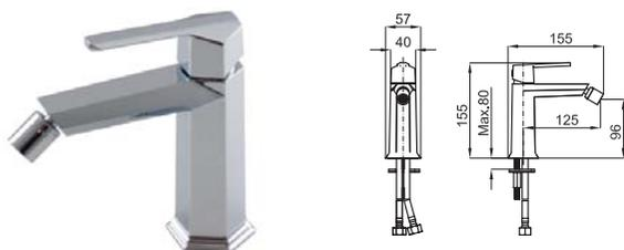
Однорычажный смеситель для биде с керамическим картриджем Ø25 мм. Подключение 3/8", длина шлангов 480-мм., без автоматического сливного клапана. Пропускная способность при 3 барах 8,32 л/мин.
