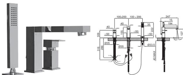
Смеситель для установки в ванне на 3 отверстия. Включает пульт, излив для ванны с переключателем и ручной душ со шлангом 150 см. Связь 3/8" и азратор "plus". Пропускная способность при 3 барах душа: 11,68 л/мин. и ванны: 16,6 л/мин.
