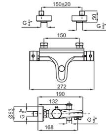
**1** BASIC - Наружный смеситель с термостатом для душа с элементом покрытия из воска. Связь 1/2". Включает обратный клапан и предохранитель на и ECOSTOP. Пропускная способность при 3 барах 25 л/мин.
